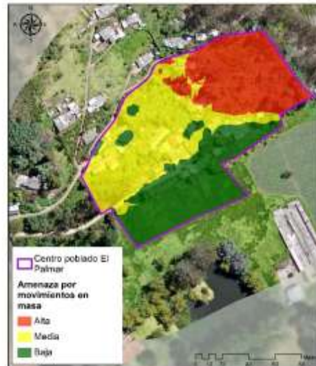
Gráfica 104 Amenaza por movimientos en masa en el centro poblado El Palmar
