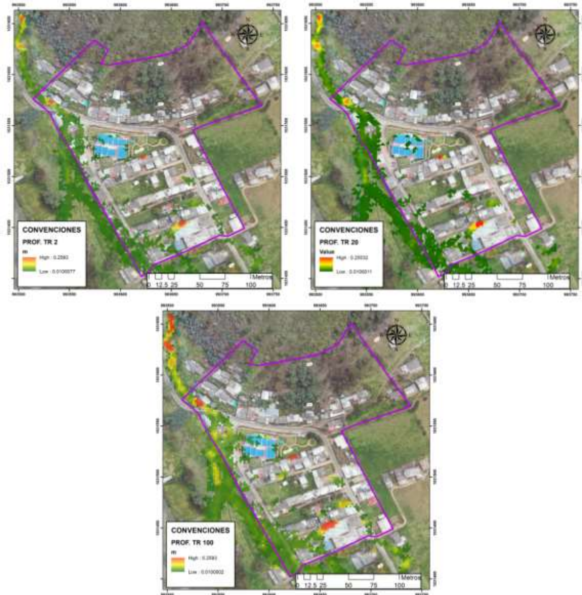
Gráfica 227. Mapas de profundidad (m/s) de la modelación de avenida torrencial para el centro poblado de Pan de Azúcar para tiempos de retorno de 2, 20 y 100 años
