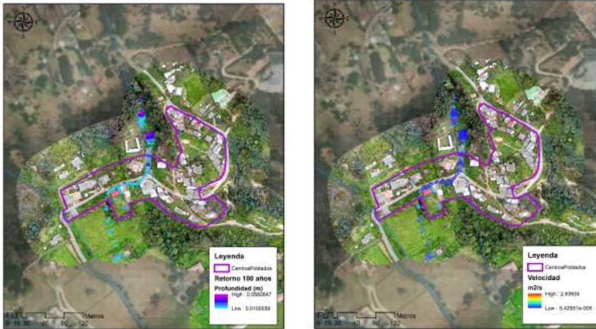
Gráfica 165 Profundidad (metros) y velocidad (m2/s) de la lámina de agua en el análisis de inundaciones para el centro poblado Cascajera
