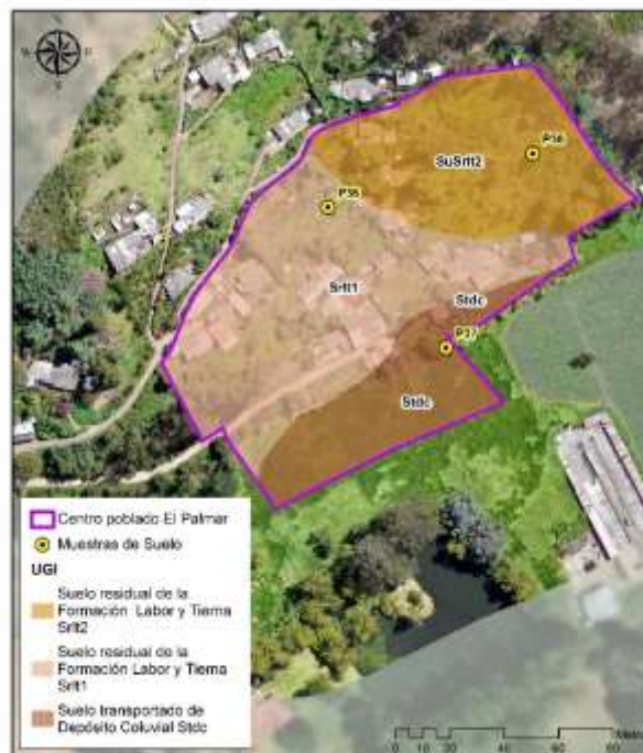
Gráfica 54 Unidades geológicas para Ingeniería (UGI) en el centro poblado El Palmar
