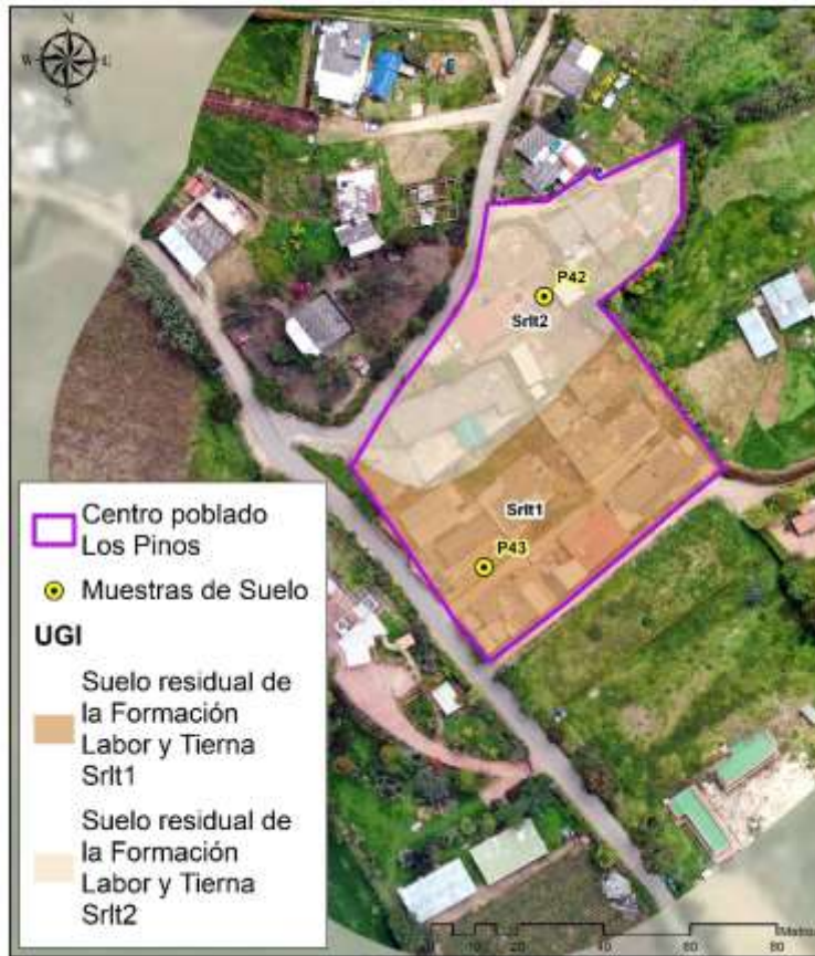
Gráfica 58 Unidades geológicas para Ingeniería (UGI) en el centro poblado Los Pinos
