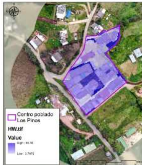
Gráfica 88 Profundidad de la tabla de agua (HW) en el centro poblado Los Pinos
