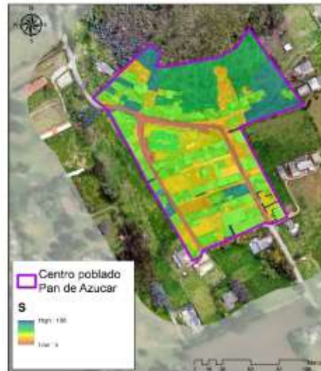
Gráfica 79 Retención Potencial máxima (S) en el centro poblado Pan de Azúcar
